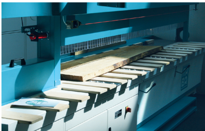
Bruchsichere Lamellen am Absaugbalken garantieren dem Bediener der Maba-Swissline Längsschnitt-Kreissäge freie Sicht auf das Werkstück
