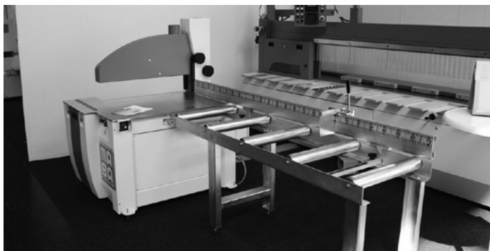
MUK 80: Die Untertisch-Kappsäge wird für die maximalen Schnittlängen 4,2 m, 5,2 m und 6,2 m angeboten
