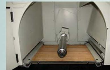
Werkstück-Andruckplatte zum Schneiden
